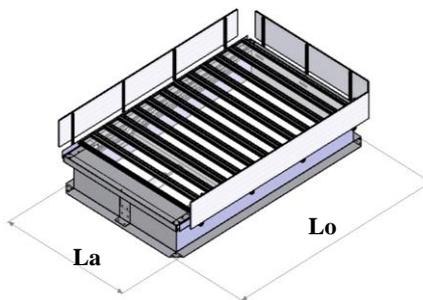
La gamme est capable d'ouvrir l'ARCALAM EVOLUTION ELECTRIQUE malgré la présence d'un vent défavorable de 10 m/s et une surcharge de : 25 kg/m<sup>2</sup> ou 50 kg/m<sup>2</sup>.
